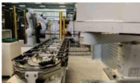
*ProxinnoV crée au sein de son usine pilote une nouvelle ligne robotique pour le démantèlement de petit électroménager et de batteries — Photo :*
