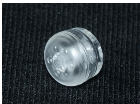
Implant microfluidique CAPDCM – coques assemblées visant à la capture des cellules tumorales.
