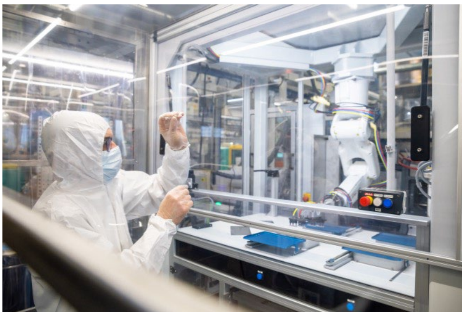
Cellule de production robotisée en salle blanche ISO 7. Source : Ludovic Godard pour DEMGY Group
