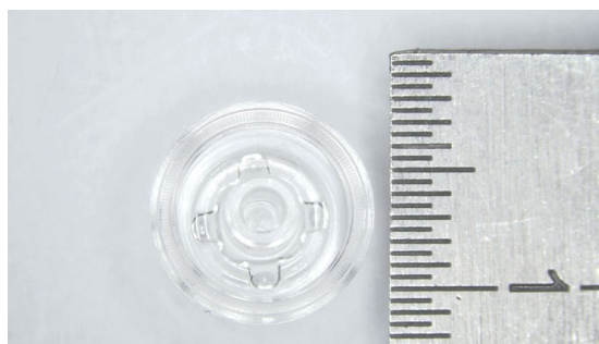
Deux demi-coques de l'implant microfluidique et vue de dessus d'une coque avec échelle.
