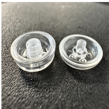
Deux demi-coques de l'implant microfluidique et vue de dessus d'une coque avec échelle.
