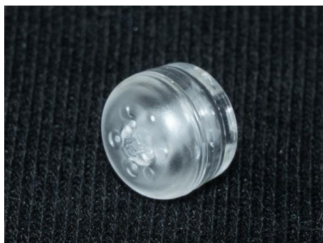
Implante microfluídico CAPDCM: semicarcasas ensambladas destinadas a la captura de células tumorales.
