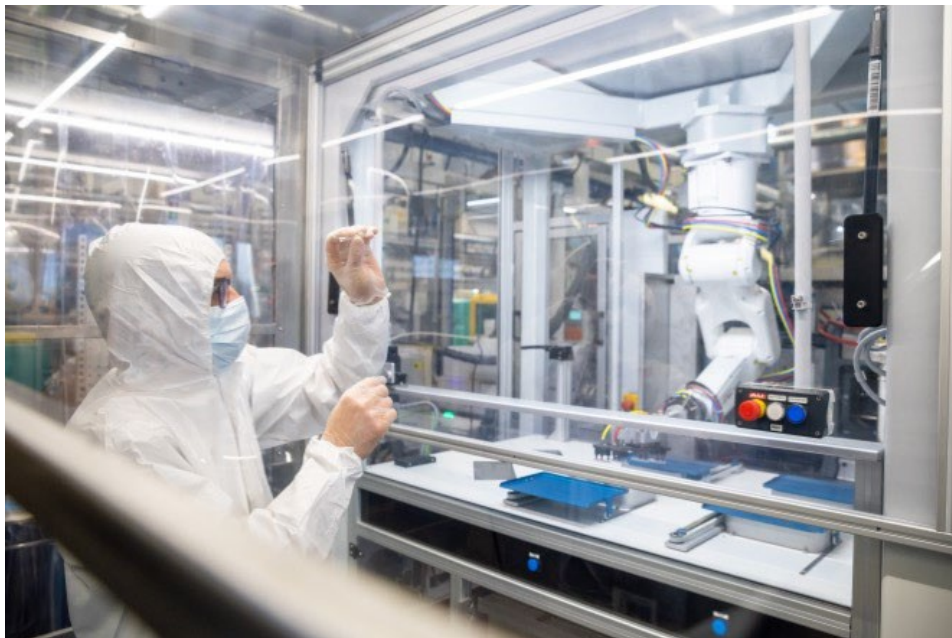
Célula de producción robotizada en sala limpia ISO 7. Fuente: Ludovic Godard para DEMGY Group
