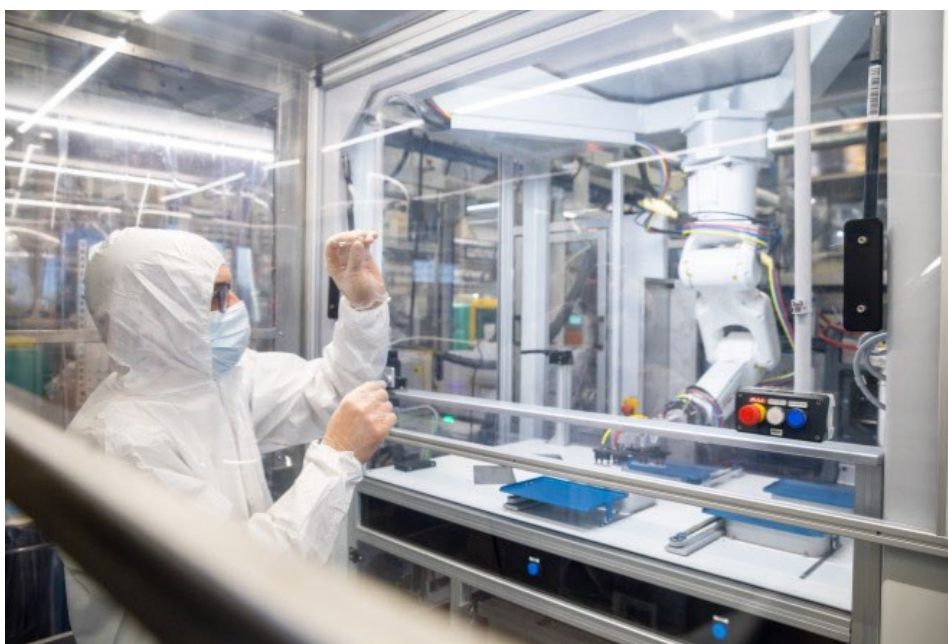
Unitate de producție robotizată în cameră albă ISO 7. Sursă: Ludovic Godard pentru DEMGY Group
