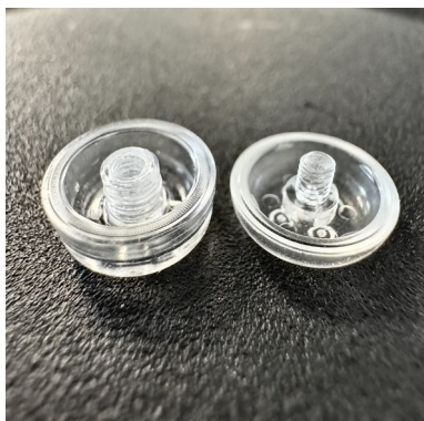
Două jumătăți de carcasă ale implantului microfluidic și vedere de sus a unei carcase cu scală.
