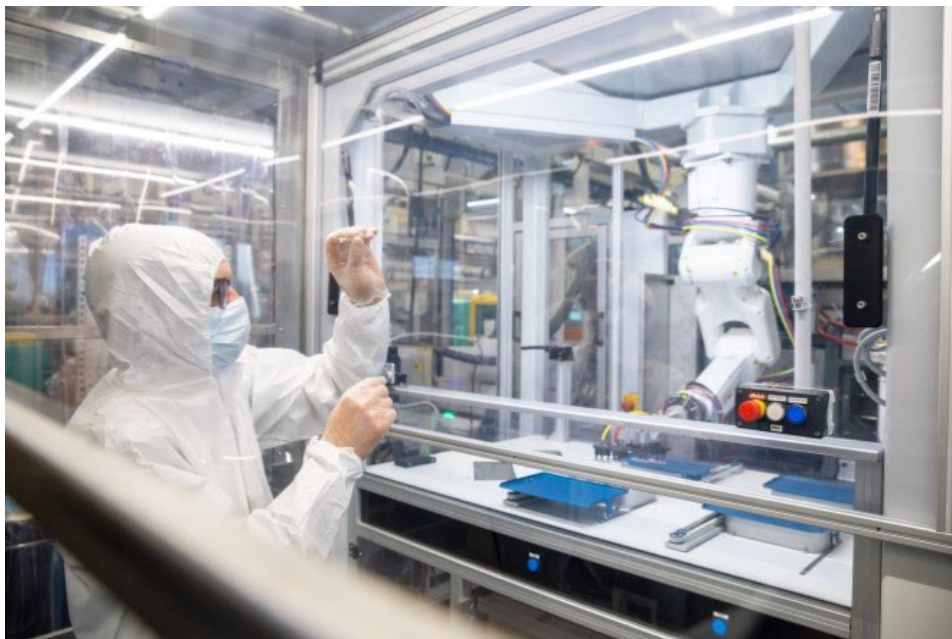
Robotergesteuerte Produktionszelle im Reinraum der Klasse ISO 7. Quelle: Ludovic Godard für die DEMGY Group
