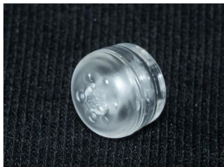
Mikrofluidik-Implantat CAPDCM – zusammengesetzte Schalen zum Einfangen von Tumorzellen.
